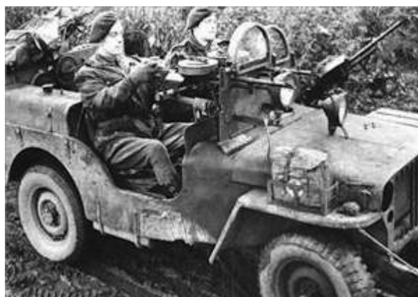
Foto: gemodificeerde SAS jeep. Duidelijk zichtbaar zijn de ronde gepantserde ruiten en dubbele Vickers machinegeweren.
